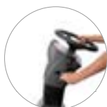
Piantone sterzo regolabile
