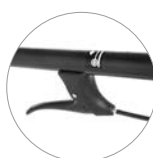
Leva attivazione trazione meccanica
