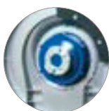
Attacco disco trascinatore e spazzole
